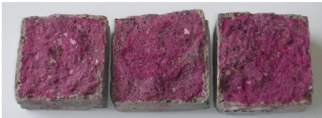
Рисунок 2 – Внешний вид бетонных образцов, обработанных проникающей гидроизоляцией «Кальматрон» после 7 суток испытаний
