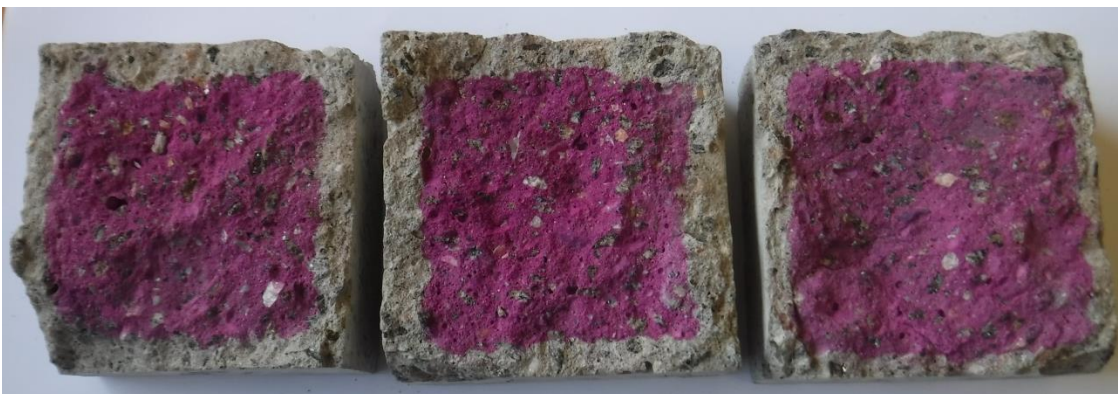
Рисунок 7 – Внешний вид контрольных бетонных образцов после 14 суток испытаний
