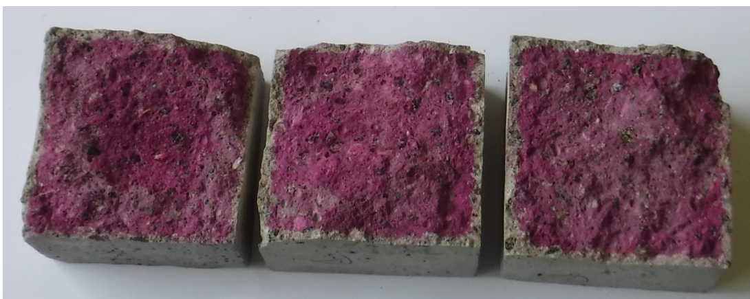
Рисунок 3 – Внешний вид бетонных образцов с добавкой в бетон «Кальматрон-Д» после 7 суток испытаний
