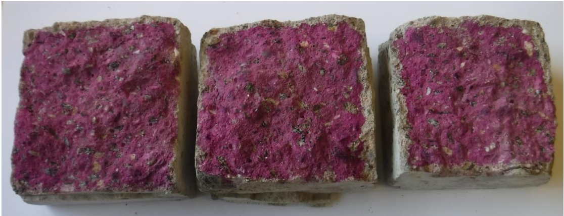
Рисунок 5 – Внешний вид бетонных образцов, обработанных проникающей гидроизоляцией «Кальматрон» после 14 суток испытаний
