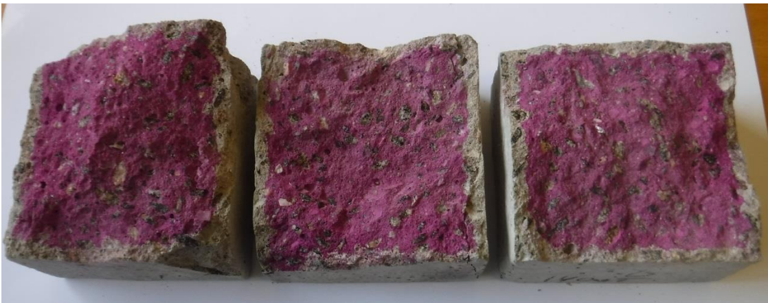
Рисунок 6 – Внешний вид бетонных образцов с добавкой в бетон «Кальматрон-Д» после 14 суток испытаний
