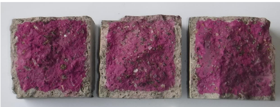
Рисунок 4 – Внешний вид контрольных бетонных образцов после 7 суток испытаний
